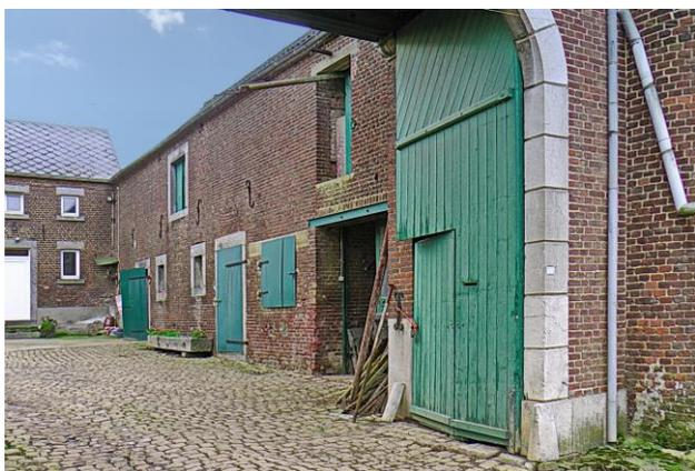
Les murs donnant sur l'extérieur présentent six jours rectangulaires en calcaire. Le toit en bâtière est aussi couvert de panneaux ondulés en éternit.
