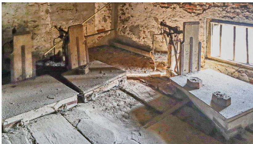
Pour nourrir le bétail, il fallait préparer des aliments secs constitués de céréales moulues et de pulpes séchées. De nombreuses machines, qui étaient utilisées à cette fin, se trouvent toujours à l'étage des anciennes écuries. C'est là que de lourds sacs de grains étaient manipulés. Une balance à bascule permettait de peser ces sacs.
