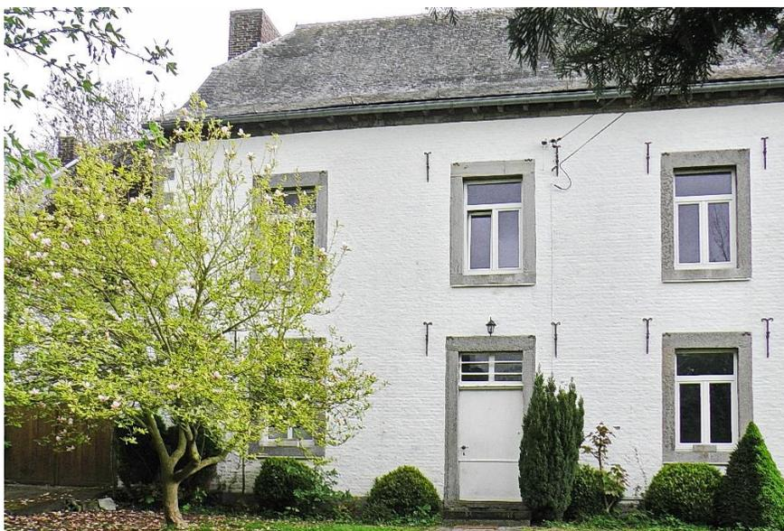
La façade est peinte en blanc et se trouve sur un soubassement en calcaire. Les baies en calcaire sont rectangulaires. La porte, au centre, se trouve sur un seuil d'une marche.
